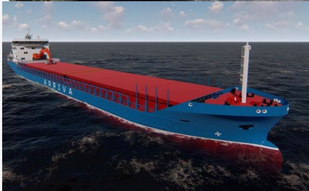
Tørrelastrederiet Arriva Shipping bestilte i 2019 et nytt tørrlastskip med batteripakke for utslippsfri inn- og utseiling til havner. 119,5 meter langt, dødvekt på 7.600 tonn.
