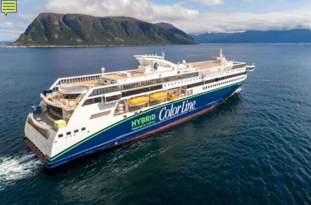
Color Hybrid verdens største ladbare hybrid skip. Batteripakke 5 MWh. Opp til 1 time manøvrering og selling på batteri inn og ut av havn.
