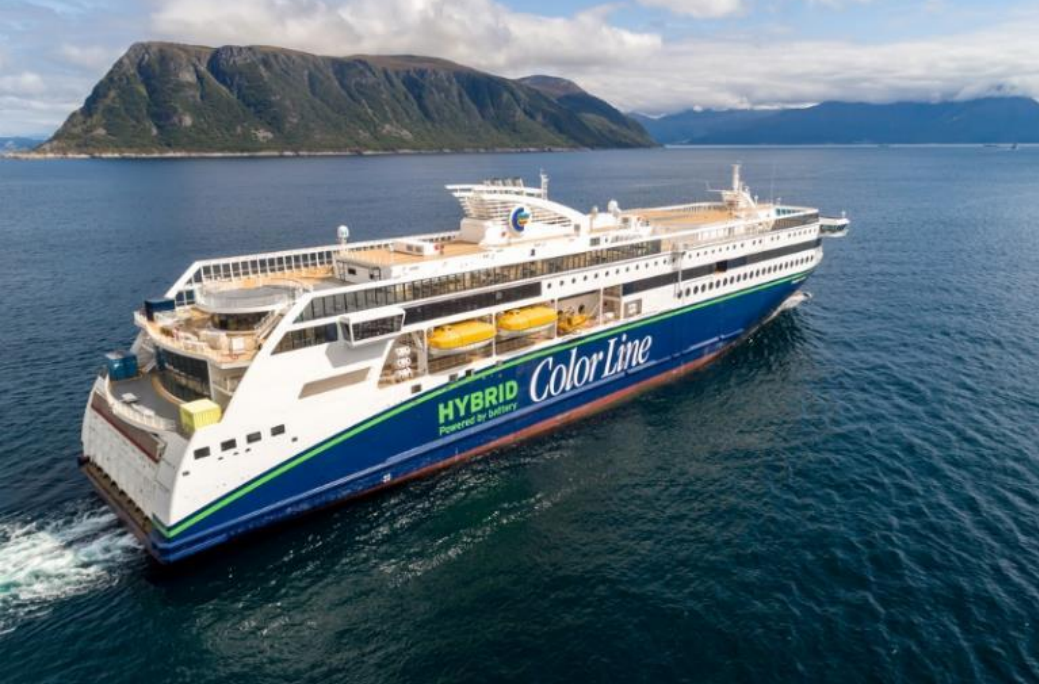
Color Hybrid verdens største ladbare hybrid skip. Batteripakke 5 MWh. Opp til 1 time manøvrering og seiling på batteri inn og ut av havn.
