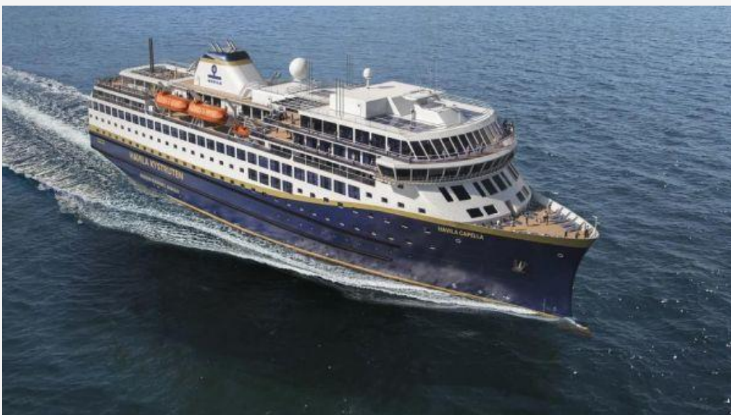
Havila Kystruten Bergen- Kirkenes med 4 ladbare hybrid skip i 2021. 6 MWh batteripakker ca. 4 timer i 10 knop på ren batteridrift.
