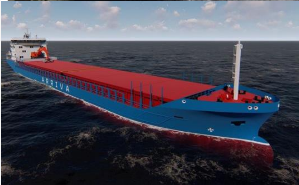
Tørrlastrederiet Arriva Shipping bestilte i 2019 et nytt tørrlastskip med batteripakke for utslippsfri inn- og utseiling til havner. 119,5 meter langt, dødvekt på 7.600 tonn.
