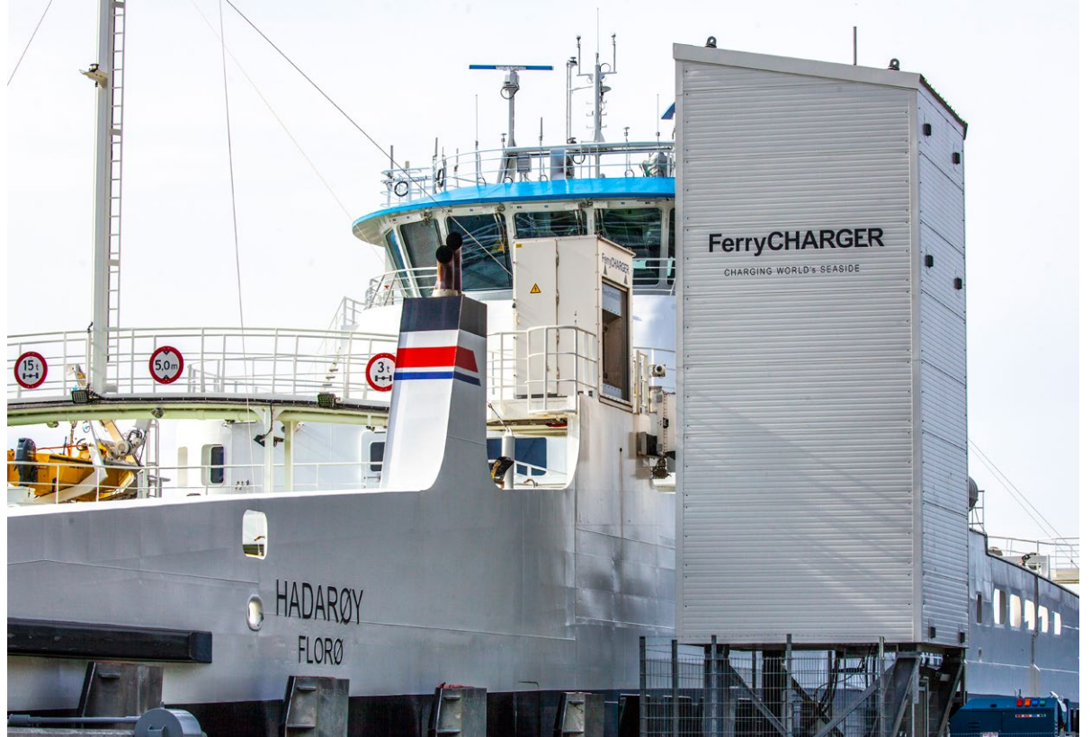
Bilfergen MF “Hadarøy” fra Fjord1 drives av batteri og trafikkerer fergestrekningen Hareid - Sulesund i Møre og Romsdal.
