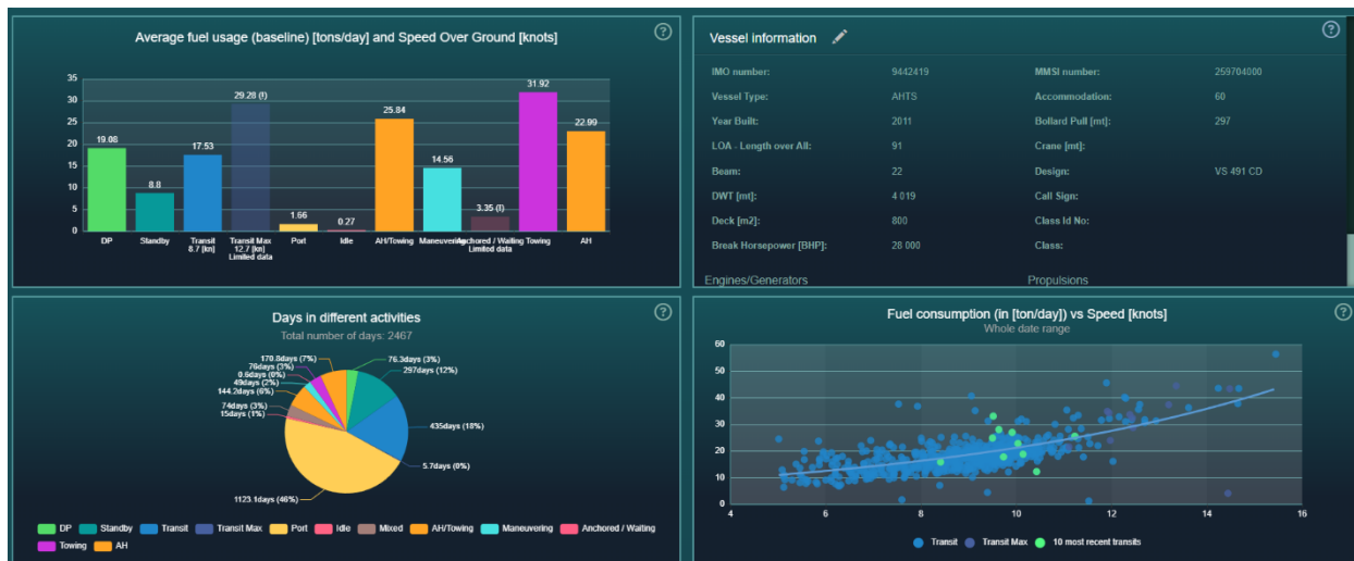
Figur 10 Programvaren Maress, øverst til venstre; viser drivstofforbruk under forskjellige aktiviteter, nederst til venstre; hvor mange dager fartøyet brukte i de forskjellige aktivitetsmoduser, øverst til høyre; fartøy informasjon, nederst til høyre; trend i drivstofforbruk i forskjellig fart. Skjerm bilde: Sea1Offshore.
