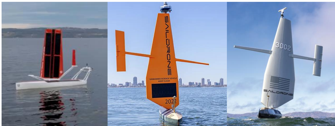
Figur 8 USV'er med energi fra vind, bølger og sol, VaneONE (4 meter) fra VaneOcean og Voyager (10 meter) og Surveyor (20 meter) fra Saildrone. Foto 1: Vane Ocean Technologies, foto 2 og 3: Med tillatelse fra Saildrone.
