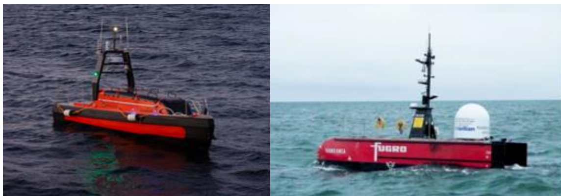
Figur 6 Mellomstore USV'er fra Kongsberg Sounder (8 meter) and Fugro Blue Essence (12 meter), Foto 1: Geir Pedersen/Havforskningsinstituttet, foto 2: Fugro
