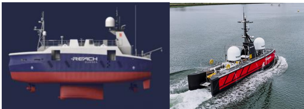
Figur 7 Store USV'er fra Reach Remote (23,9 meter) og Fugro Blue Eclipse (18 meter). Foto 1: Reach Subsea, foto 2: Fugro.
